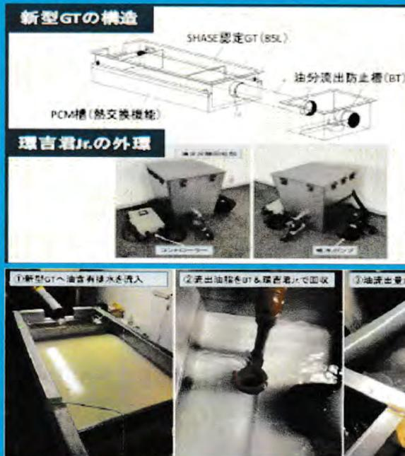
施設内の厨房に設置されているグリース阻集器(GT)からの配管詰り等による油分流出事故が多発している。その解決方法として油分流出防止技術を商品化
