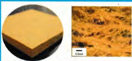
細かくした木質素材を水を使い成形する「湿式製法」による断熱材商品
