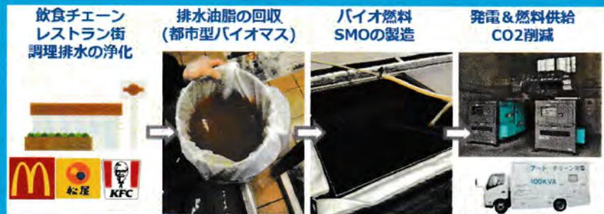
排水浄化の過程で分離回収する排水油脂から生み出す新エネルギーシステム商品
