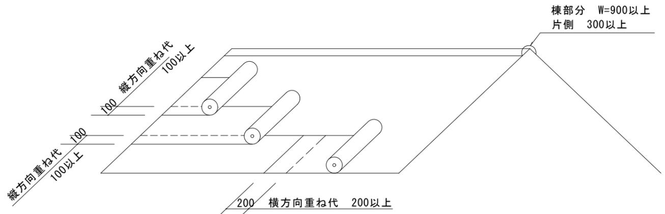
注：勾配5寸未満、流れ長さ10m以上は止水性の高い改良アスファルトルーフィングを使用する
